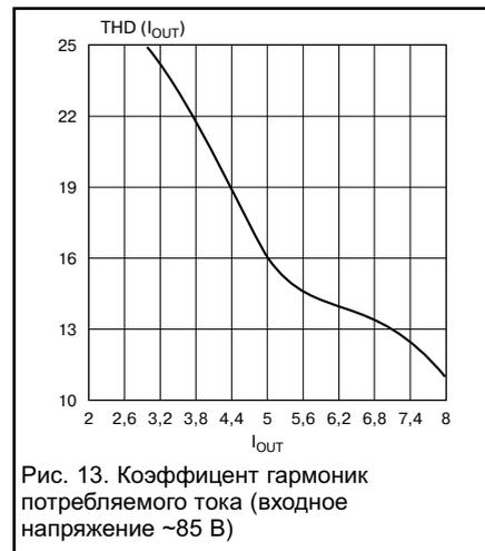
Рис. 13. Коэффициент гармоник потребляемого тока (входное напряжение ~85 В)
