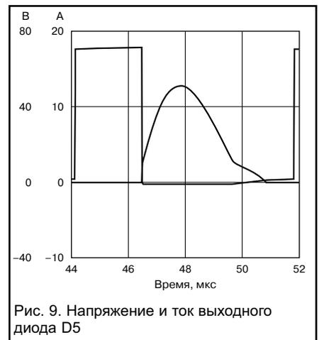
Рис. 9. Напряжение и ток выходного диода  $D5$
